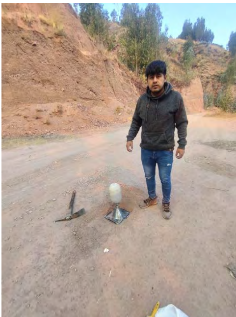
Gráfico 41. Densidad del Suelo In situ en la Sub Rasante
