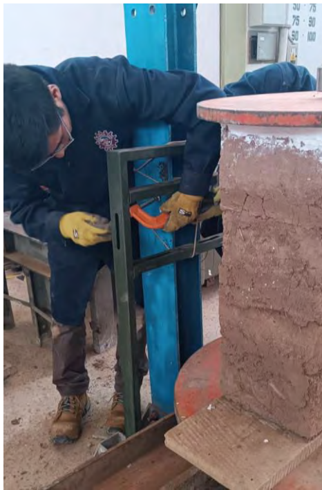
Fotografía 35: Colocado de diales de deformación para ensayo de compresión de pilas
