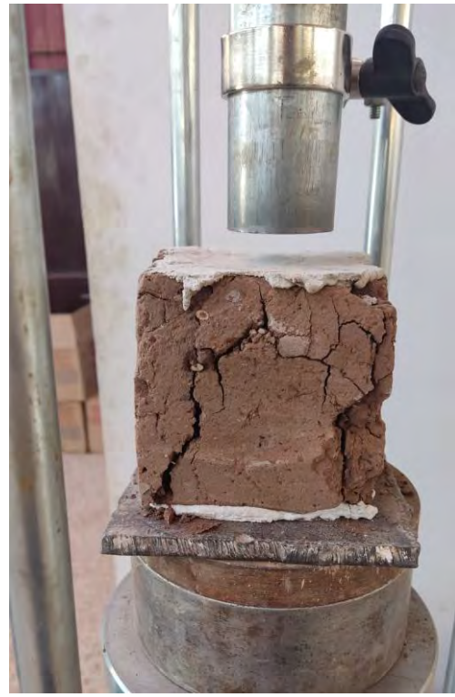
Fotografía 26: Falla de muestra de adobe
