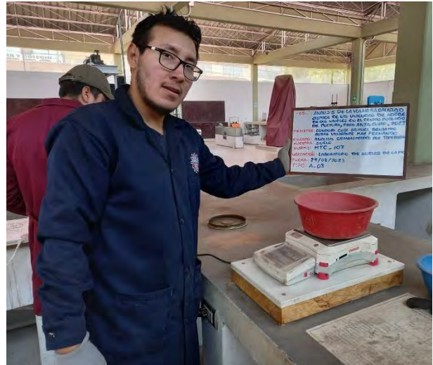
Fotografía 18: Pesado de muestra de suelo
