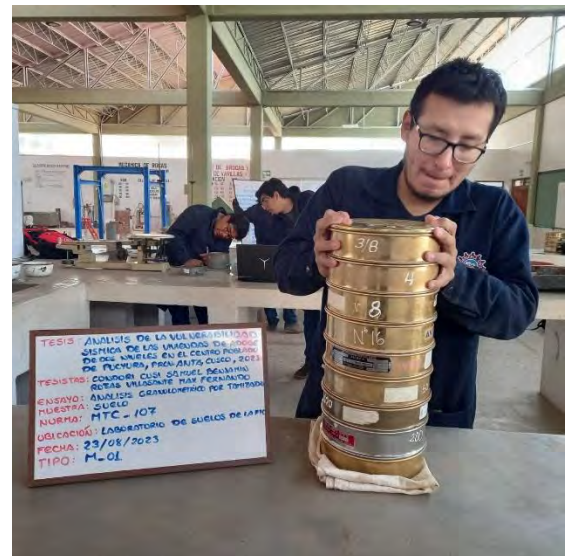
Fotografía 16: Tamizado de muestra de suelo
