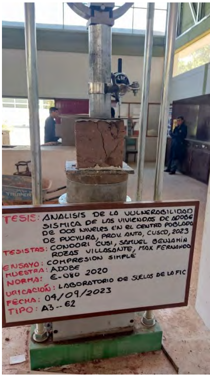
Fotografía 25: Muestra de adobe luego del ensayo de compresión simple
