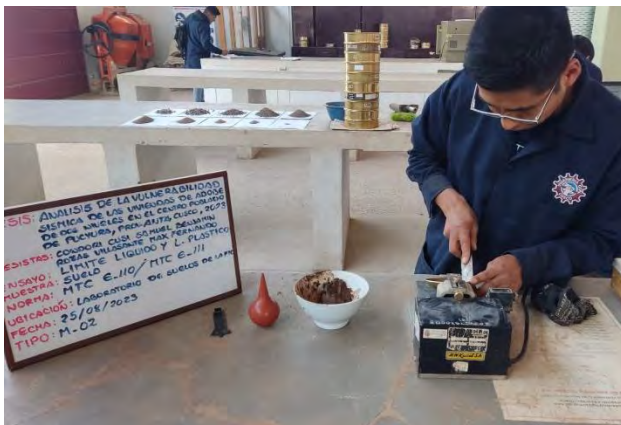
Fotografía 19: Determinación del límite líquido
