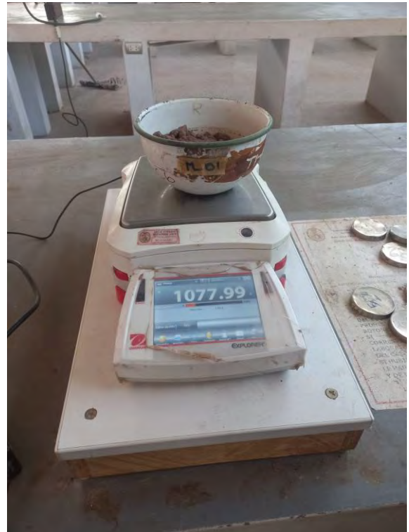
Fotografía 14: Pesado de muestra seca luego del lavado
