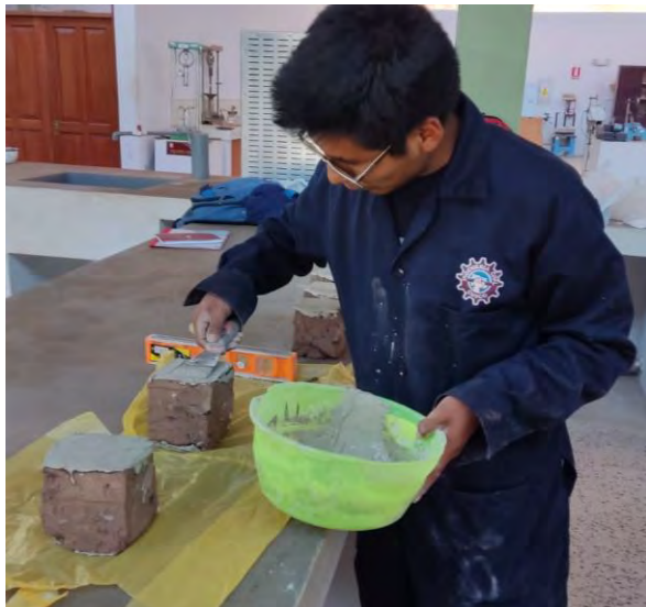
Fotografía 23: Colocado de Capping sobre muestras de adobe de 10 cm de arista
