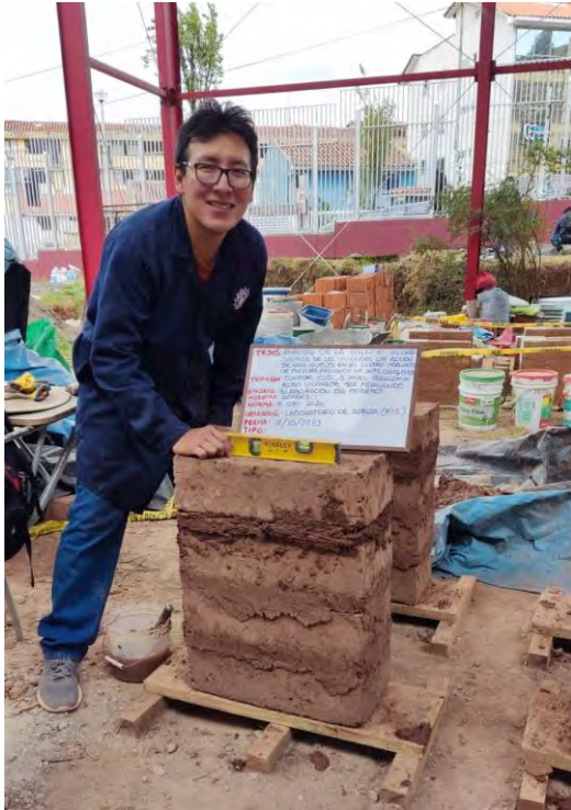
Fotografía 33: Elaboración de pilas de adobe
