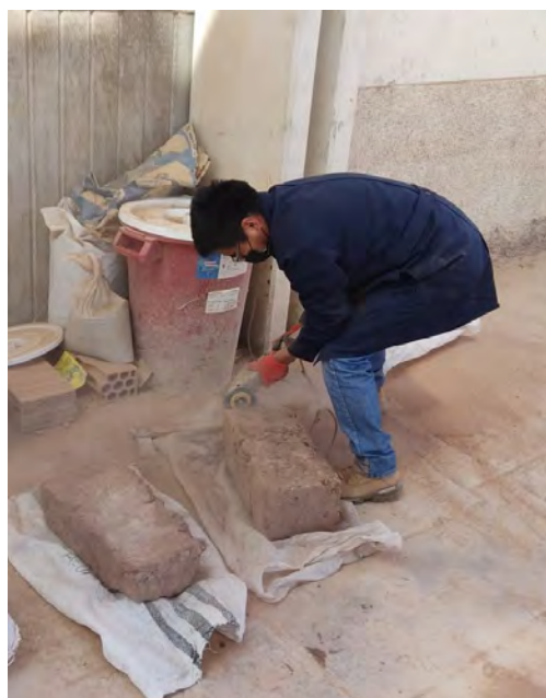
Fotografía 10: Tallado de muestra de adobe con amoladora.
