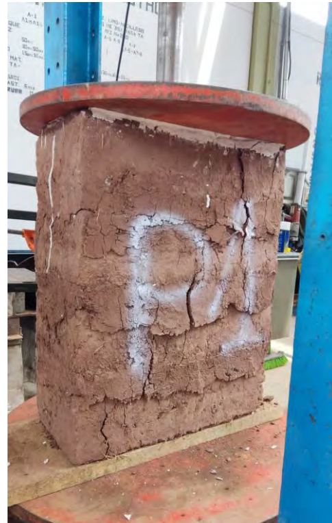
Fotografía 38: Falla de pila N°01 luego del ensayo
