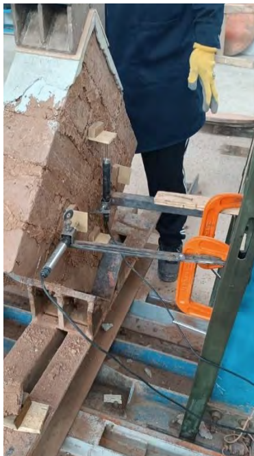
Fotografía 39: Colocado de diales de deformación para ensayo de compresión diagonal de muretes
