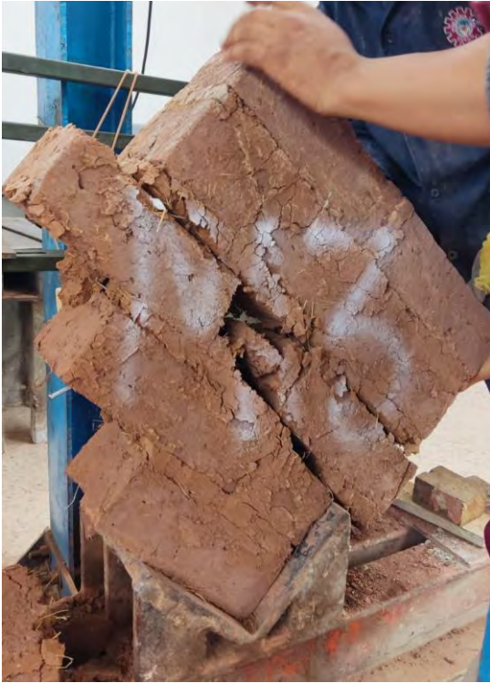
Fotografía 41: Falla de Murete 03 luego del ensayo de compresión diagonal
