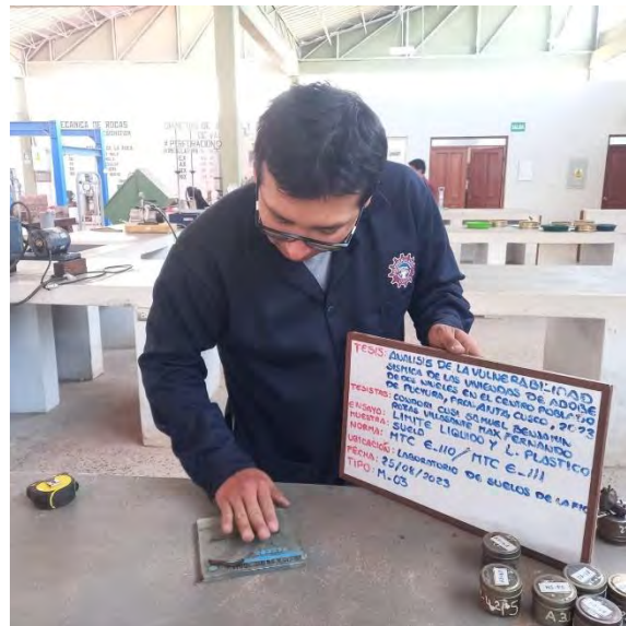
Fotografía 20: Determinación del límite plástico
