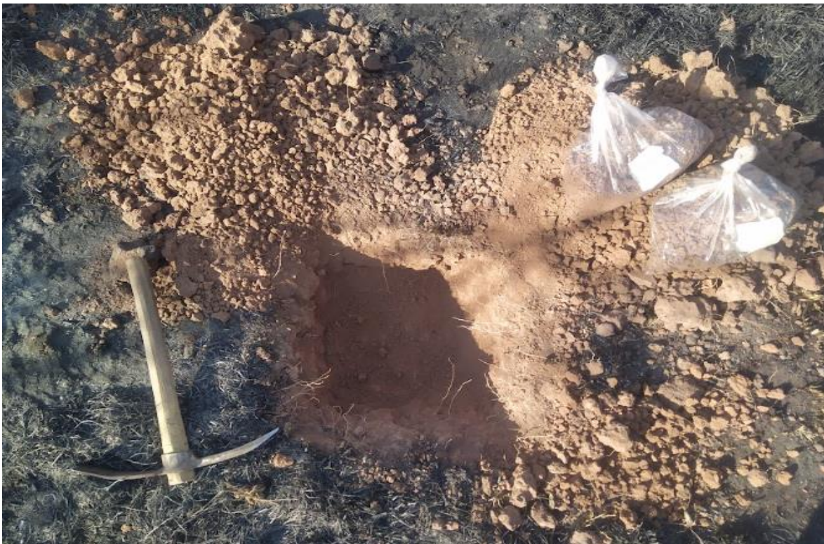
Fotografía 01: Apertura de calicatas
