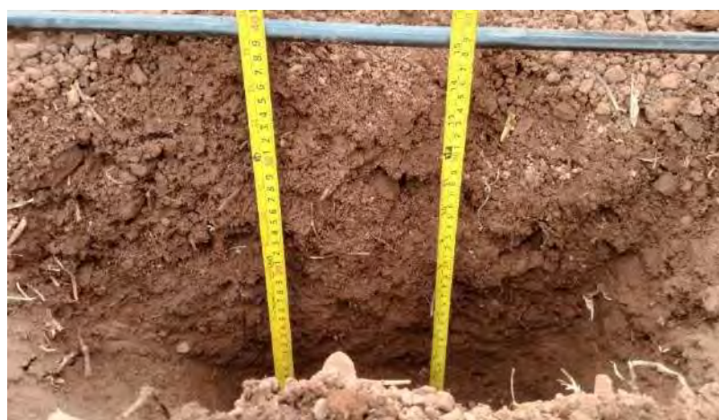
i) Formación de bulbo húmedo en parcela con una pendiente de 40% a un tiempo de irrigación por 45 minutos.
