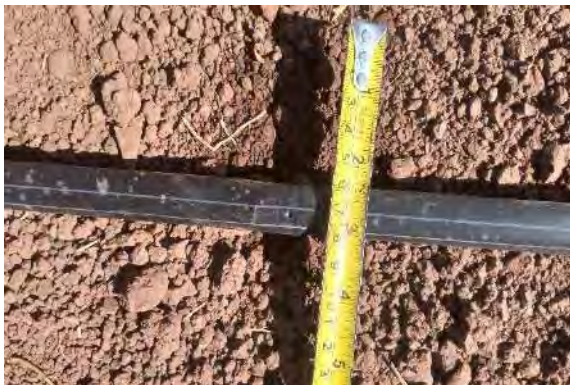
Diámetro del suelo mojado ( \Phi = 10\text{cm} )
