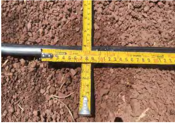
Diámetro del suelo mojado ( \Phi = 16\text{cm} )
