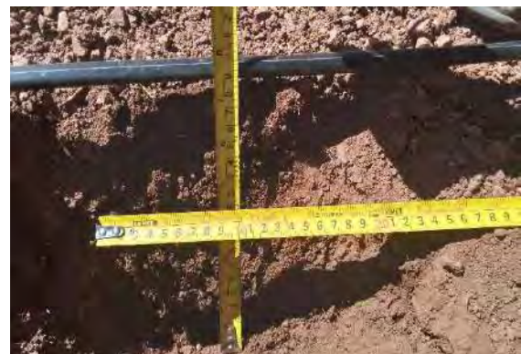
Profundidad de bulbo húmedo ( h = 19\text{cm} )
