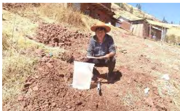
f) Registro de caudal en la entrada al sistema de riego.
