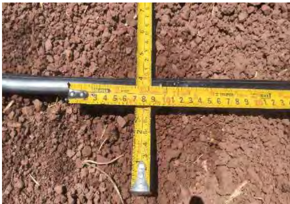
Diámetro del suelo mojado ( \Phi = 16\text{cm} )
