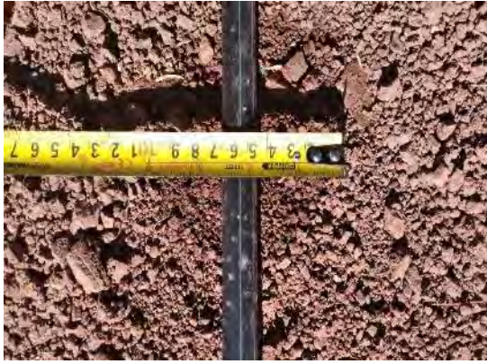
Diámetro del suelo mojado ( \Phi = 10\text{cm} )
