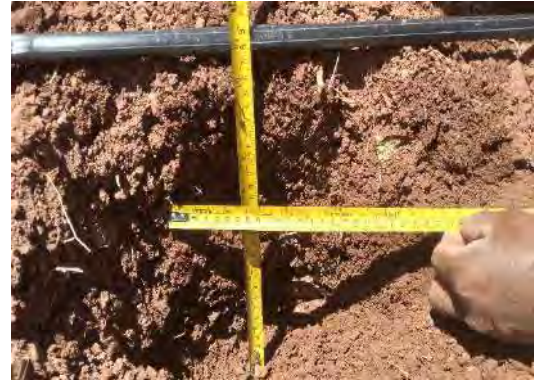
Profundidad de bulbo húmedo ( h = 24\text{cm} )
