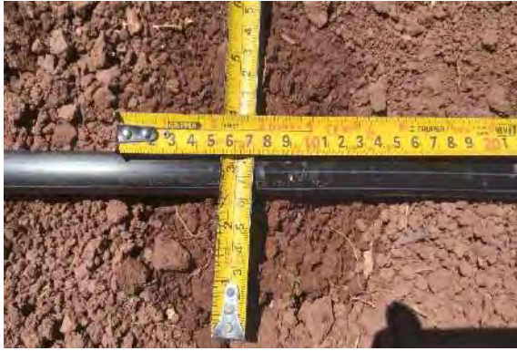
Diámetro del suelo mojado ( \Phi = 14\text{cm} )
