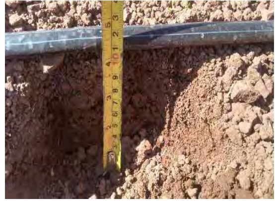
Profundidad de bulbo húmedo ( h = 11\text{cm} )
