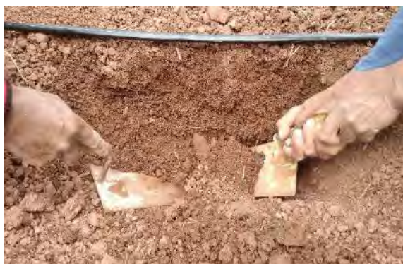
c) Calicata del suelo mojada, utilizando material badilejo para extraer tierra.
