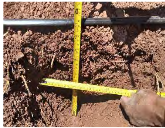
Profundidad de bulbo húmedo ( h = 26\text{cm} )
