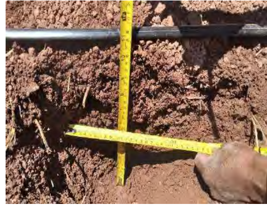
Profundidad de bulbo húmedo ( h = 26\text{cm} )
