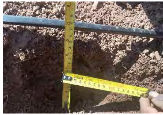
Profundidad de bulbo húmedo ( h = 16\text{cm} )
