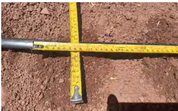
Diámetro del suelo mojado ( \Phi = 15\text{cm} )
