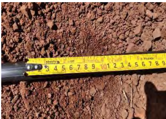
Diámetro del suelo mojado ( \Phi = 11\text{cm} )
