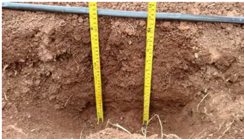
h) Formación de bulbo húmedo en parcela con una pendiente de 20% a un tiempo de irrigación por 45 minutos.
