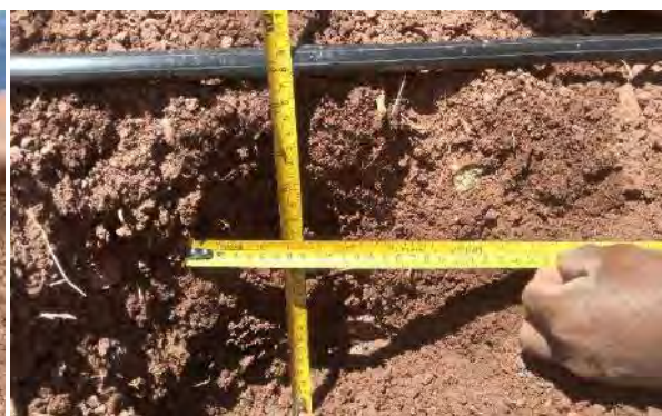
e) Medicion de los resultados de la formacion de bulbo humedecimiento del suelo.
