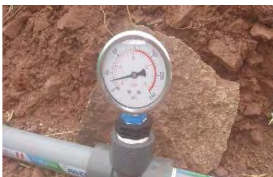
a) Registro de presión con manómetro de glicerina 1/4", (0-16 BAR).
