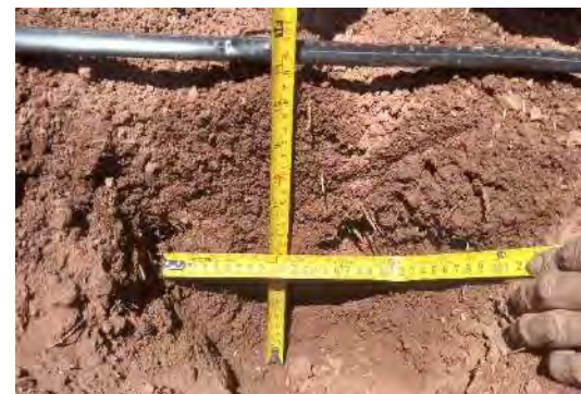
Profundidad de bulbo húmedo ( h = 27\text{cm} )
