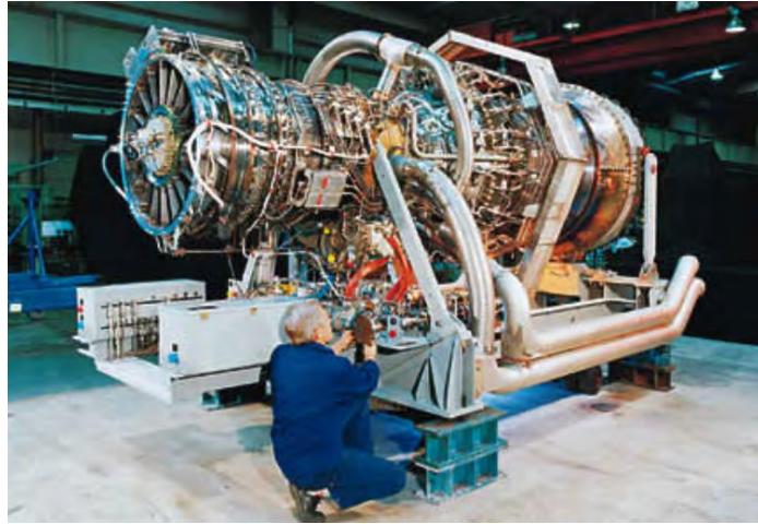
Figura 32. Turbina de gas tipo aeroderivada en mantenimiento
