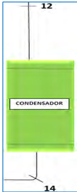
Figura 89. Condensador en el punto 12 y 14 del ciclo de vapor propuesto
