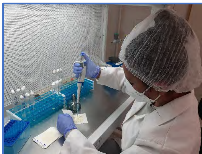
Figura 21. Siembra en 3M™ Placas Petrifilm™ Staph Express para recuento de Staphylococcus aureus.
