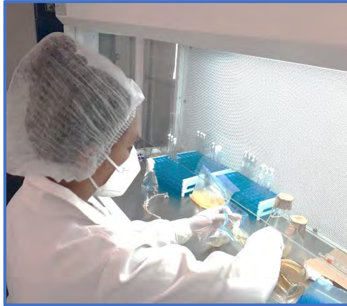
Figura 16. Preparación de dilución utilizando 90 ml de diluyente 3M™ Agua de peptona Buferada ISO en cada bolsa ziploc con 10 g de queso triturado.
