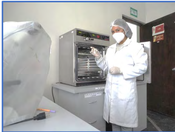
Figura 23. Preparación de la incubadora disponiendo de agua destilada en un vaso precipitado para mantener la humedad.
