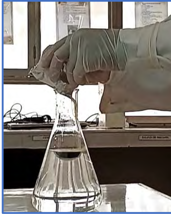
Figura 35. Preparación de diluyente utilizando 185 g de diluyente deshidratado 3M™ Enriquecimiento base para Salmonella en 5000 ml de agua destilada para las 20 muestras.
