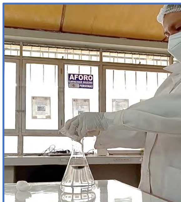
Figura 11. Preparación de diluyente utilizando 51 g de 3M™ Agua de peptona Buferada ISO deshidratado a 2000 ml de agua destilada.
