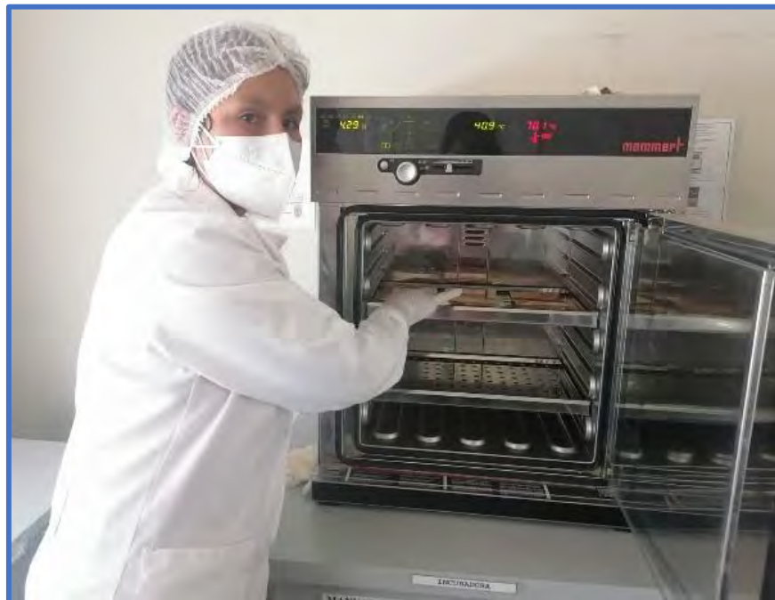
Figura 50. Incubación de todas las Placas 3M™ Petrifilm™ Salmonella Express (SALX) sembradas en posición horizontal con el lado coloreado hacia arriba a una temperatura de 41.5°C durante 24 horas.
