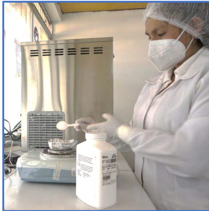
Figura 10. Preparación de diluyente utilizando 51 g. de 3M™ Agua de peptona Buferada ISO deshidratado.
