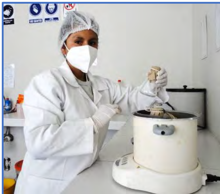
Figura 9. Esterilización de materiales en autoclave durante 15 min.
