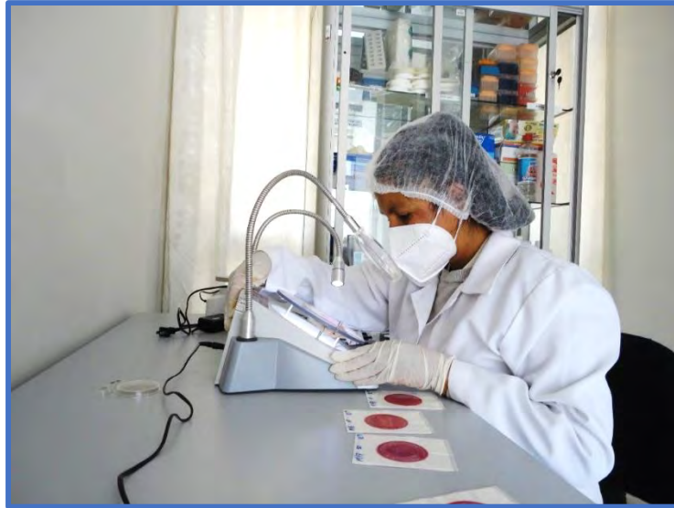
Figura 26. Recuento de colonias de E. coli /Coliformes en las Placas Petrifilm™ para recuento de E. coli /Coliformes utilizando el contador de colonia (Shuett biotec).
