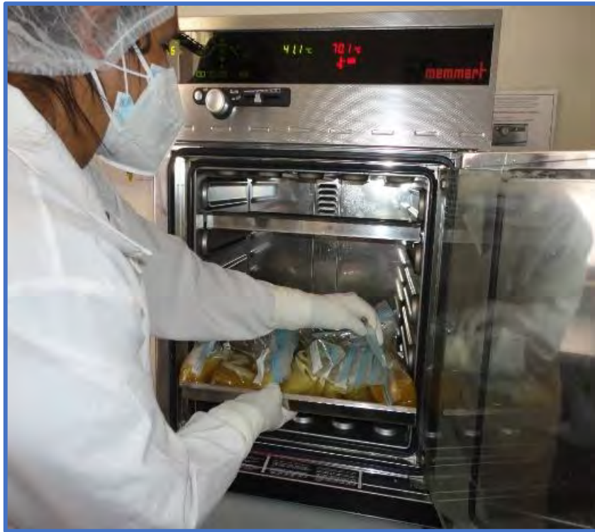
Figura 45. Incubación del medio de cultivo más el queso triturado por 24 h a una temperatura de 41.5°C.
