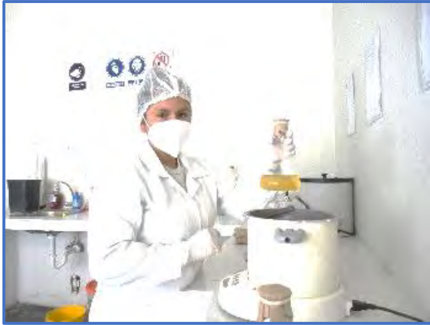
Figura 37. Esterilización del diluyente 3M™ Enriquecimiento base para Salmonella en autoclave a una temperatura de 121°C por 15 minutos.
