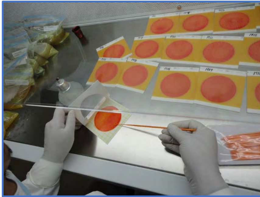
Figura 49. Siembra de las Placas 3M™ Petrifilm™ Salmonella Express (SALX) por estriado, desde la parte superior hasta la parte inferior con un asa de 3 mm de diámetro.
