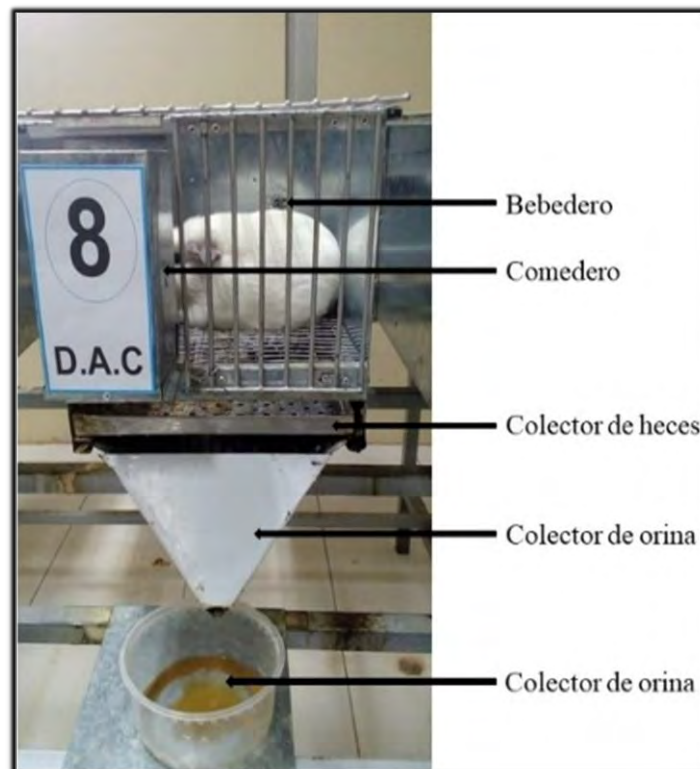
Figura 1. Jaula metabólica del estudio
