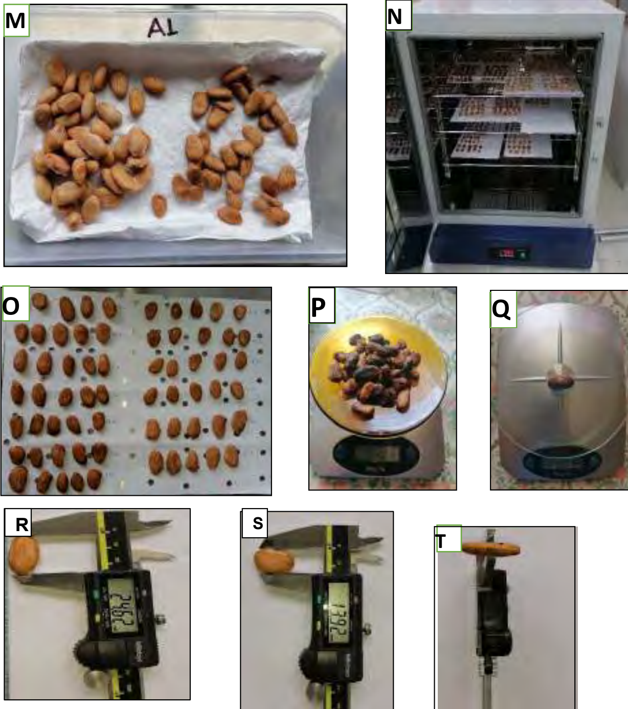
La Foto 13 , muestra M) Semillas sin mucílago, N) Semillas secadas en estufa, O) Semillas secas, P) Pesado de semillas secas, Q) Pesado de semilla seca, R) Longitud de la semilla, S) Diámetro de la semilla y T) Grosor de la semilla.
