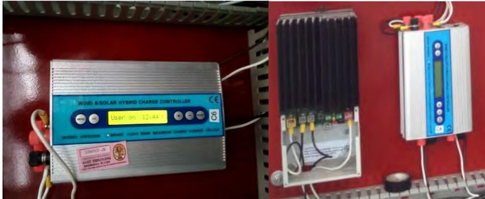
*Figura 7. Controlador de carga y disipador de energía.*
