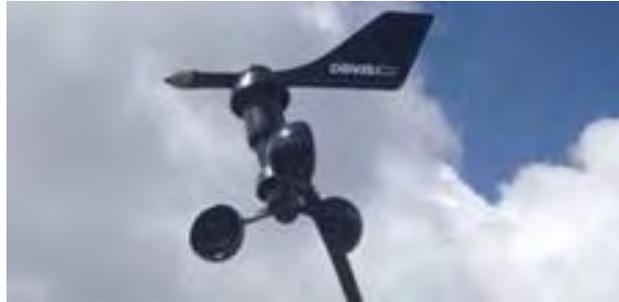
**Figura 2.** Anemómetro de la estación meteorológica Vantage Pro2.
