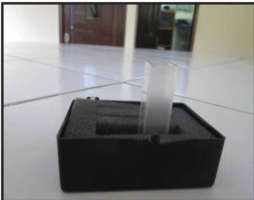
Foto 08: Cubeta de cuarzo de 5ml de capacidad
