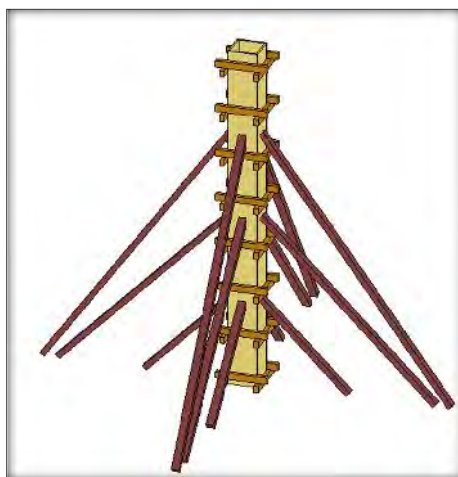
Figura 47. Encofrado en Columnas (Fuente: Revit - Elaboración Propia)
