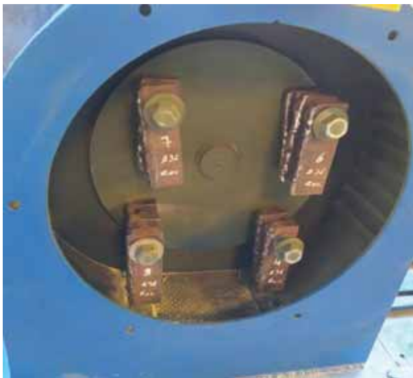
Figura 3. 26 Martillos de acero ASTM A 36 recubiertos con AWS A5.13-EFeCr-A8.
