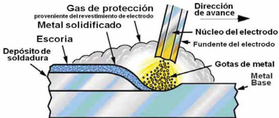
Figura 2.7 Proceso de soldadura por arco eléctrico
