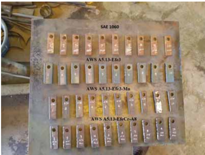
Figura 3. 28 Recopilación de los datos de las probetas después de las pruebas de abrasión
