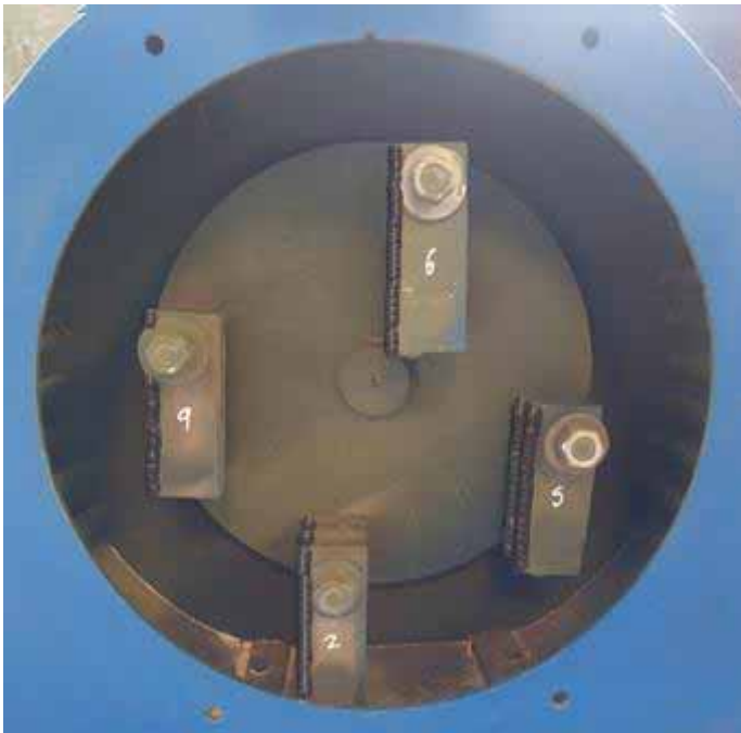
Figura 3. 24 Chancadora de martillos de acero ASTM A36 recubiertos con AWS A5.13-EFe3
