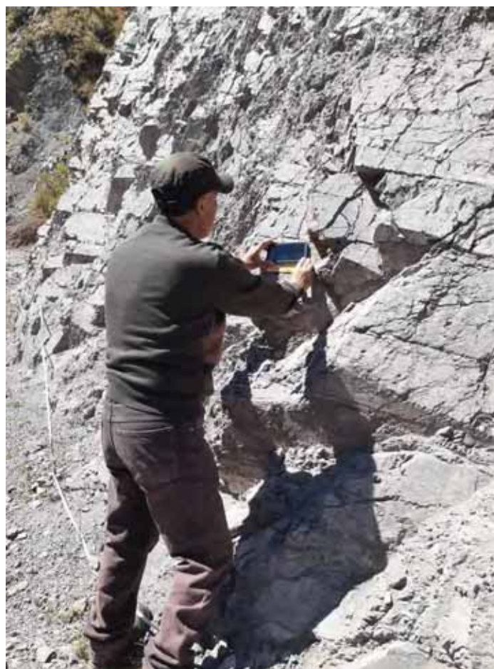
Comprobación de Dureza de roca con Picota Zona Ccaccañan.Tambobamba
