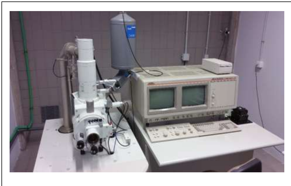
Figura 88: SEM JEOL JSM 6300-Universidad La Laguna- España.
