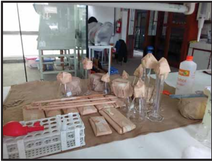
FOTO N°13. Esterilización de materiales de laboratorio para el control microbiológico
