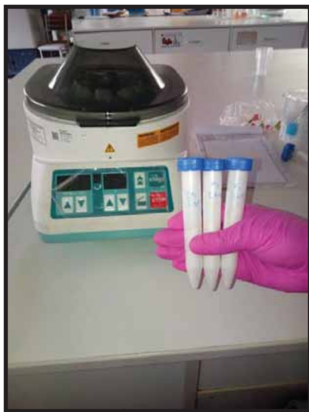
FOTO N°7. Determinación de la estabilidad de la crema por centrifugación a 2500 rpm
