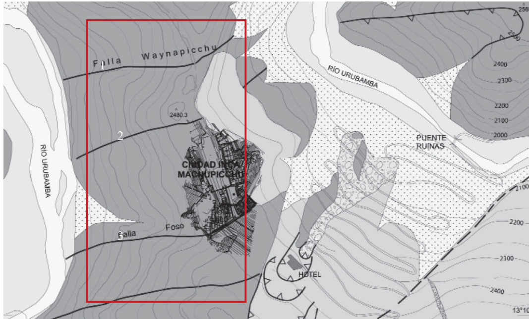
Figura 2.3: Sistema de Fallas de formación en la Llaqta Inca de Machupicchu; identificado por Kalafatovich (1963), con dirección NO – SE que cruzan la Llaqta, siendo las representativas: (1) la falla de Waynapicchu, (2) falla de Machupicchu, y (3) falla Foso Seco. Adaptado de Carlotto, Cárdenas y Fidel, 2009.
