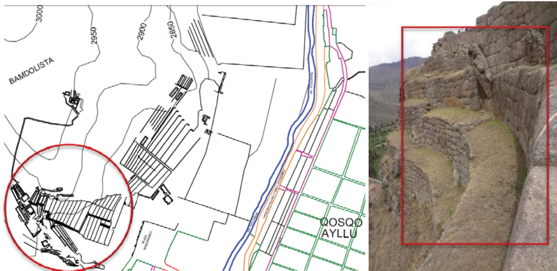
Figura 5.19: Características topográficas de la Llaqta Inca de Ollantaytambo . Los elementos topográficos artificiales utilizado por los Incas como: muros de contención, andenes, plataformas artificiales, se incorporan condicionados al paisaje natural, conservando, resaltando y favoreciendo la formación de un paisaje de calidad. Adaptado de Plan Maestro del Parque Arqueológico de Ollantaytambo, 2005. Fotografía, archivo personal, 2017.
