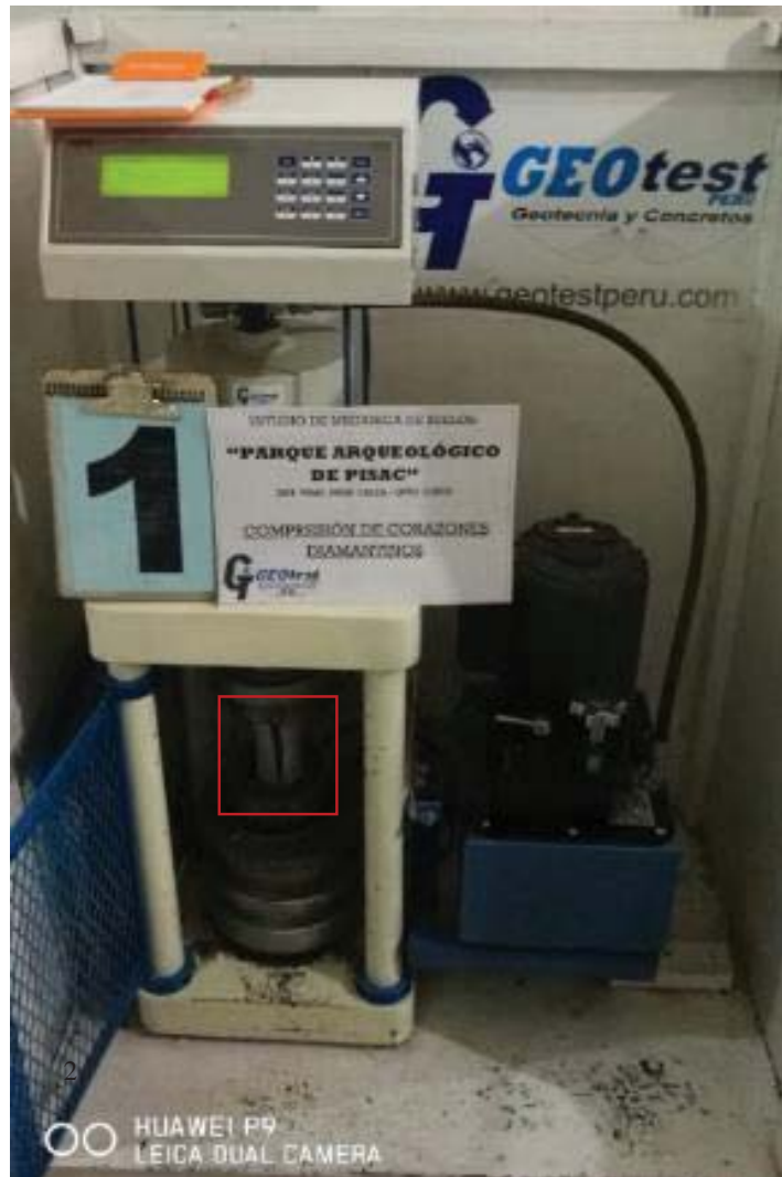
Figura 2.14: Ensayos de Compresión Simple no Confinada; (1) Muestras de corazones diamantinos de los macizos rocosos; (2) Ensayo de Compresión Simple No Confinada. “Con las muestras procedentes de la prospección geotécnica se realizan los ensayos de laboratorio... según la finalidad del Estudio, pueden ser de los tipos...: a) Ensayos de Clasificación; b) Ensayos de Resistencia...” (Rodríguez et.al., 1989, p.24). Fotografías, archivo personal, 2017.
