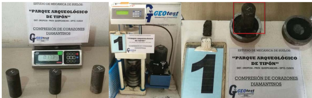
Figura 5.72: Ensayos de Compresión Simple No Confinada, de suelos de fundación de la Llaqta Inca de Tipón . (1) Corazones diamantinos de macizo rocoso de Andesita basalto; (2) Ensayo de Compresión de la Muestra; (3) Muestra ensayada, el espécimen resultante casi intacto, con un promedio de f'c = 315 \text{ Kg. / Cm}^2 , demostrándose la dureza del macizo rocoso. Fotografías, archivo personal, 2017.
