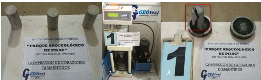
Figura 5.70: Ensayos de Compresión Simple No Confinada, de suelos de fundación de la Llaqta Inca de Písaq . (1) Corazones diamantinos de macizo rocoso Andesita; (2) Ensayo de Compresión; (3) Muestra promedio de f'_c = 689 Kg./Cm2. Fotografías, archivo personal, 2017.
