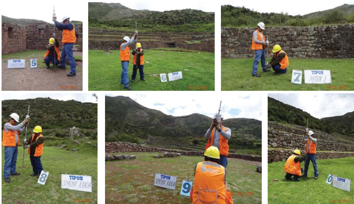
Figura 5.37: c-01 Distribución de Puntos de Investigación en la Llaqta Inca de Tipón , con Penetrómetro Dinámico Liger. Se investigó en las Plataformas agrícolas, Iglesia Raqui, Cancha Inca y Sinkuna Cancha. Fotografías, archivo personal, 2017.
