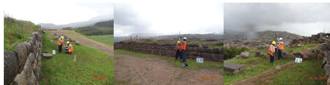
Figura 5.38: C-01 Distribución de Puntos de Investigación en la Llaqta Inca de Saqsaywaman. Investigamos el Sector denominado Baluartes; donde se ha distribuido 11 puntos de investigación, cubriendo todo el área del Sector y, conseguir la mayor cantidad de lecturas, a partir de los Ensayos Penetrómétricos; en, Recintos, Plazas y Patios; no teniendo acceso a Plataformas agrícolas ni muros de contención. Fotografías, archivo personal, 2017.
