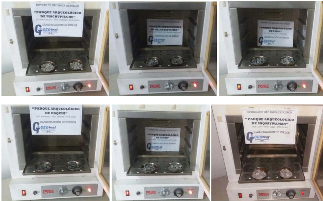
Figura 5.54: Ensayos de Contenido de Humedad . Se realizan a los suelos conformantes de los Rellenos Controlados Inca, RCI , de las Llaqtas Incas de Machupicchu, Ollantaytambo, Pisaq, Raqchi, Tipón y Saqsaywaman. Fotografías, archivo personal, 2017.
