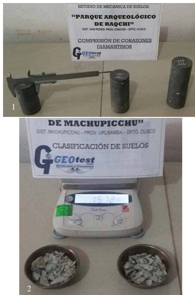
Figura 5.53: Muestras de Suelo para Laboratorio. (1) Raqchi, Tres unidades de una misma muestra de suelo, para los ensayos de Compresión Simple No Confinada; (2) Machupicchu, dos unidades para ensayos de Caracterización de suelos. Fotografías, archivo personal, 2017.
