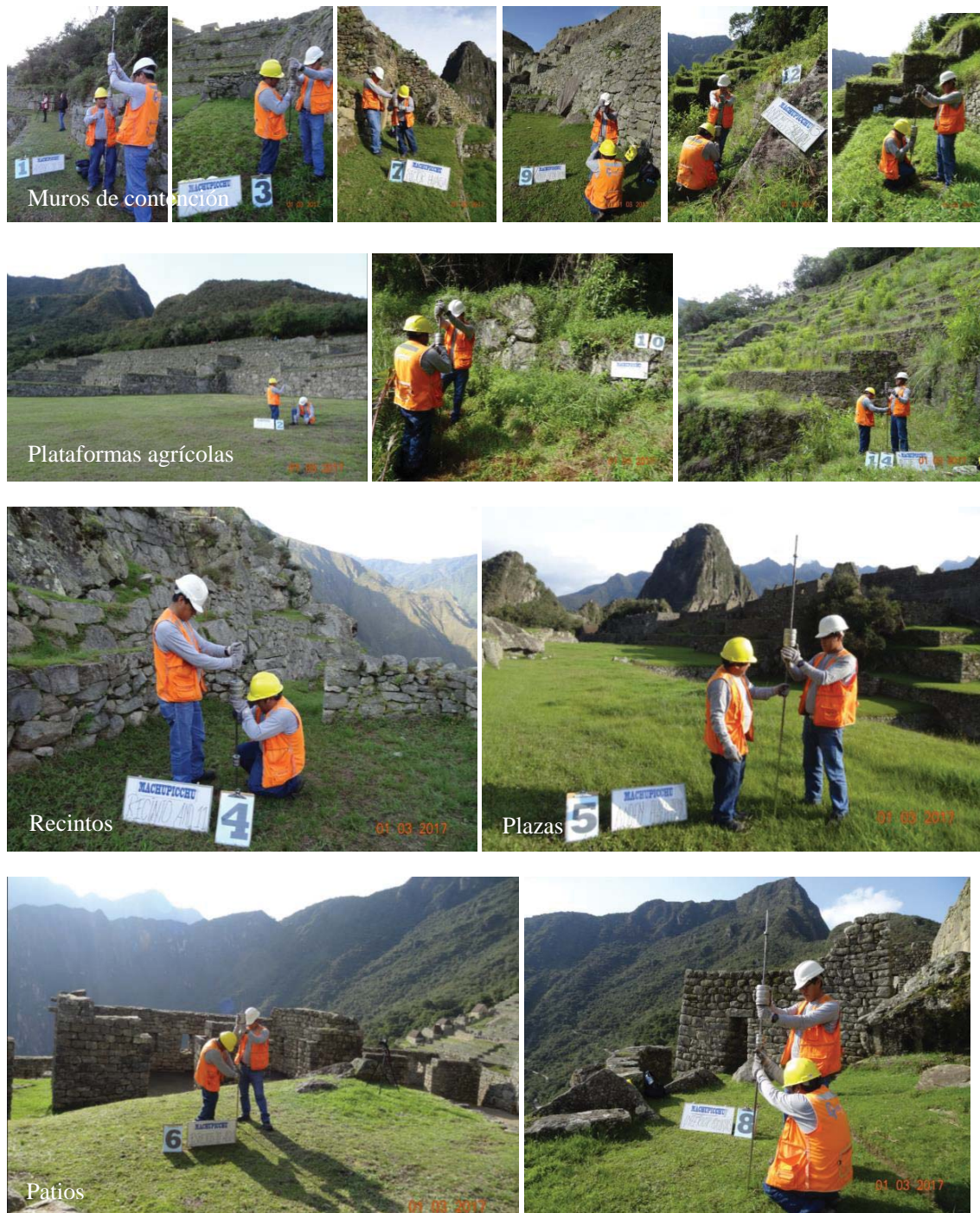
Figura 5.41: Ensayos In Situ con Penetrómetro Dinámico Ligero, en la Llaqta Inca de Machupicchu ; realizados en muros de contención, plataformas agrícolas, recintos, plazas y patios; los sondeos, prueban el manejo de Rellenos Controlados Inca poco profundos y, la cercana presencia de los macizos rocosos de fundación, debido al poco desarrollo del sistema edáfico; ello, a excepción de las plataformas agrícolas, conformadas por más capas de suelos finos y orgánico, en la estratigrafía. Se distingue el tratamiento de Rellenos Controlados Inca para cada tipo de superestructura que conforman la Llaqta. Fotografías, archivo personal, 2017.
