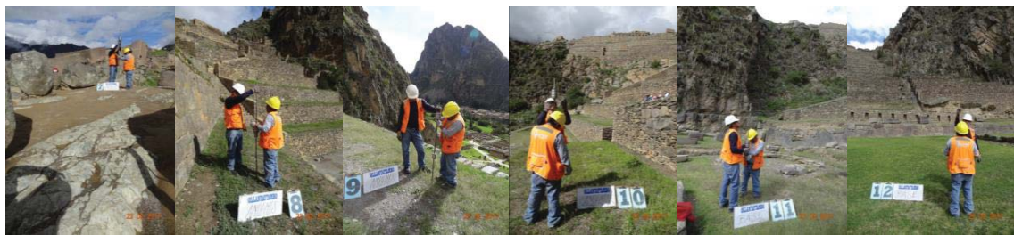
Figura 5.34: ■ Distribución de Puntos de Investigación con Penetrómetro Dinámico Ligerero, en la Llaqta Inca de Ollantaytambo . Si bien, el suelo de fundación está constituido por roca del tipo arenisca - cuarcítica, cuyas características son las mismas en todo el emplazamiento de la Llaqta; el objeto de distribuir el mayor número posible de puntos de investigación en la Llaqta, se debe a conocer los espesores o potencias de los Rellenos Controlados Incas, para cada tipo de superestructura Inca; que a su vez, nos indica a qué profundidad se encuentra el macizo rocoso de fundación, verificándose, que se maneja espesores específicos para cada tipo, como se demostrará en las siguientes páginas. Fotografías, archivo personal, 2017.
