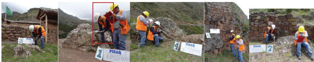
Figura 5.49: Ensayos Esclerométricos, en la Llaqta Inca de Písac , realizados en macizos rocosos aflorantes, que constituyen los suelos de fundación de las superestructuras de la Llaqta. El esclerómetro se sujeta firmemente en una posición que permita transmitir mediante el vástago un impacto perpendicular a la superficie de ensayo; después del impacto, se anota el valor del índice de rebote. Fotografías, archivo personal, 2017.
