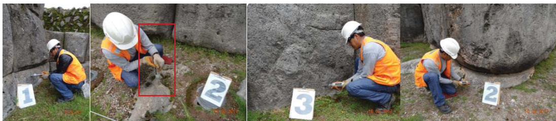
Figura 5.52: Ensayos Esclerométricos, en la Llaqta Inca de Saqsaywaman , realizados en macizos rocosos aflorantes, que constituyen los suelos de fundación de las superestructuras de la Llaqta. Es recomendable, contrastar estos resultados, con ensayos de Compresión Simple no Confinada en Laboratorio, de los macizos rocosos. Fotografías, archivo personal, 2017).
