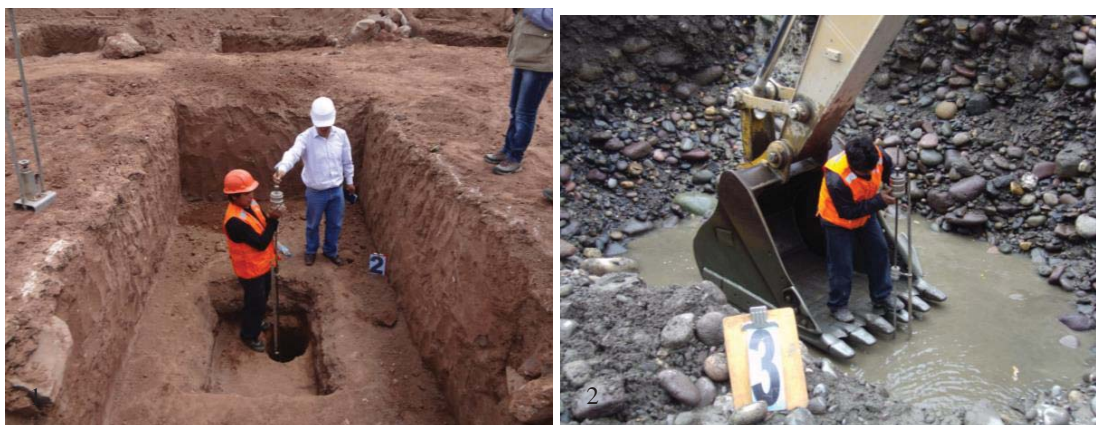
Figura 2.13: Ensayos In Situ, con el equipo Penetrómetro Dinámico Ligero, (PDL). (1) Sin presencia de Nivel Freático; (2) con presencia de Nivel Freático. Fotografías, facilitadas por GEOTEST PERÚ, 2017.
