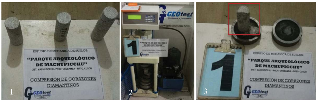
Figura 5.68: Ensayos de Compresión Simple No Confinada, de suelos de fundación de la Llaqta Inca de Machupicchu . (1) Corazones diamantinos de macizo rocoso de Granodiorita; (2) Ensayo de Compresión de la Muestra; (3) Muestra ensayada, casi íntegra, presentan en promedio 771 Kg. /Cm2 de resistencia a la compresión. Fotografías, archivo personal, 2017.
