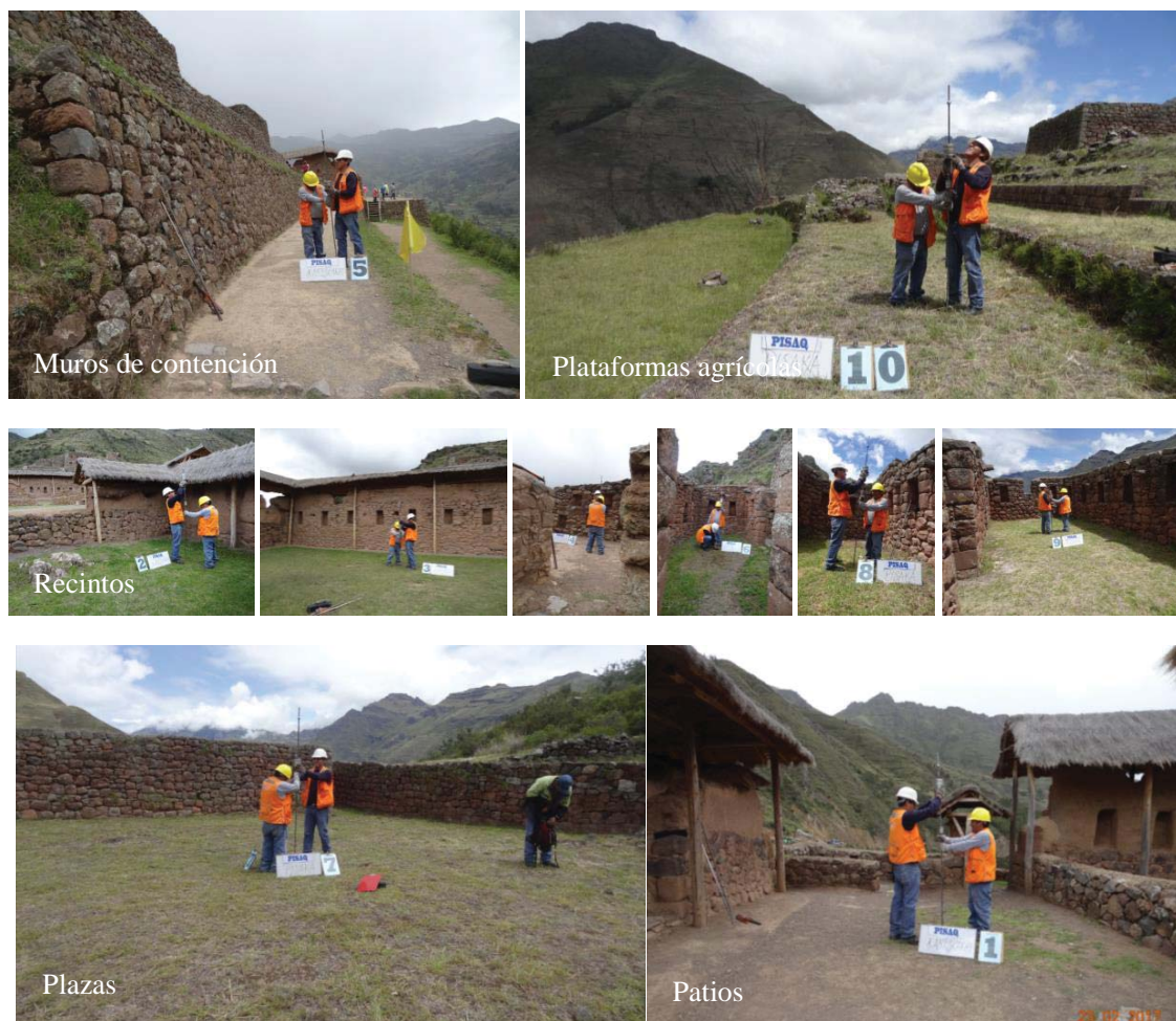
Figura 5.43: Ensayos In Situ con Penetrómetro Dinámico Ligero, en la Llaqta Inca de Pisac , realizados en muros de contención, plataformas agrícolas, recintos, plazas y patios; los sondeos realizados en esta Llaqta, evidencian el manejo de Rellenos Controlados Inca casi superficiales por la cercana presencia de los macizos rocosos de fundación; ello debido al poco desarrollado sistema edáfico del lugar. Aquí, las plataformas agrícolas por su función, presentan mayor número de capas de suelos finos, granulares y orgánico en la estratigrafía. Se distingue bastante bien el tratamiento de Rellenos Controlados Inca para cada tipo de superestructuras conformantes de la Llaqta. Fotografías, archivo personal, 2017.
