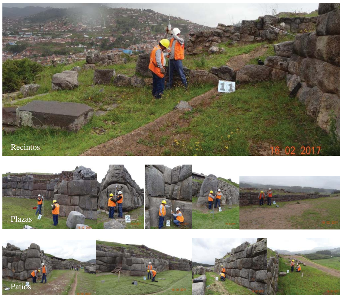
Figura 5.46: Ensayos In Situ con Penetrómetro Dinámico Ligero, en la Llaqta Inca de Saqsaywaman , realizados en recintos, plazas y patios; los sondeos realizados en esta Llaqta, evidencian el manejo de Rellenos Controlados Inca profundos por la alejada presencia de los macizos rocosos de fundación; esto debido a masivos rellenos desarrollados con la finalidad de lograr una superficie homogénea. Se distingue bien el tratamiento de Rellenos Controlados Inca para cada tipo de superestructuras conformantes de la Llaqta. Fotografías, archivo personal, 2017.
