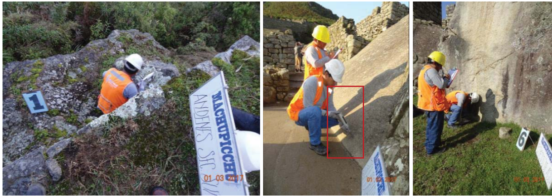
Figura 5.47: Ensayos Esclerométricos, en la Llaqta Inca de Machupicchu ; realizados en macizos rocosos aflorantes, que constituyen los suelos de fundación de las superestructuras de la Llaqta. Se toman, al menos 10 lecturas con el fin de disponer de una estimación fiable del índice de rebote de la zona de ensayo. Fotografías, archivo personal, 2017.
