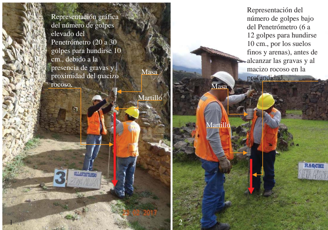
Figura 5.40: Ensayos In Situ, con el Equipo Penetrómetro Dinámico Ligero. El objetivo es obtener propiedades de resistencia mecánica y propiedades índices en los emplazamientos de las Llaqtas Incas de Machupicchu, Ollantaytambo, Pisaq, Raqchi, Tipón y Saqsaywaman. (1) Ollantaytambo , donde los macizos rocosos se encuentran cerca de la superficie y, el número de golpes del Penetrómetro es elevado para la penetración, por la resistencia de la roca; (2) Raqchi , donde el macizo rocoso se encuentra a mayor profundidad, precedido por suelos finos (como las arcillas) y granulares (Gravas), por lo que el número de golpes es bajo y el Penetrómetro se hunde con mayor facilidad, hasta alcanzar la profundidad del macizo rocoso. Fotografías, archivo personal, 2017.
