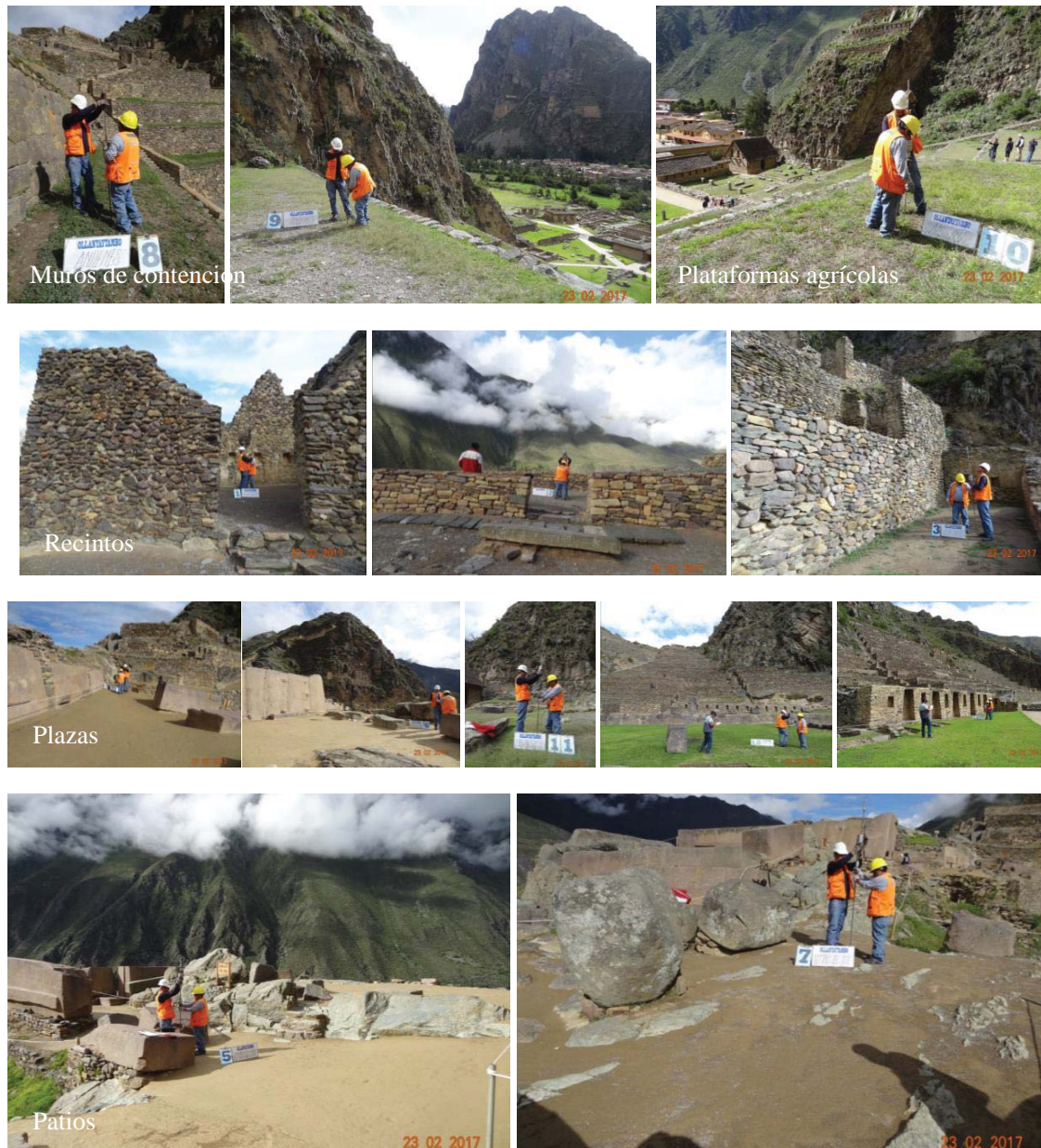
Figura 5.42: Ensayos In Situ con Penetrómetro Dinámico Ligero, en la Llaqta Inca de Ollantaytambo ; realizados en muros de contención, plataformas agrícolas, recintos, plazas y patios; los sondeos realizados en esta Llaqta, evidencian el manejo de Rellenos Controlados Inca casi superficiales, por la cercana presencia de los macizos rocosos de fundación; esto tiene que ver, con el limitado desarrollo del sistema edáfico en la zona. Las plataformas agrícolas, por su función, presentan mayor número de capas de suelos finos, granulares y orgánico en la estratigrafía; y en consecuencia, mayor profundidad. Es clara la distinción en el tratamiento de Rellenos Controlados Inca respecto a cada una de las superestructuras conformantes de la Llaqta. Fotografías, archivo personal, 2017.
