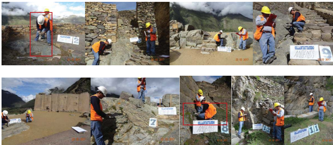
Figura 5.48: Ensayos Esclerométricos, en la Llaqta Inca de Ollantaytambo ; realizados en macizos rocosos aflorantes, que constituyen los suelos de fundación de las superestructuras de la Llaqta. Es importante anotar la posición y orientación del esclerómetro para cada conjunto de lecturas, pudiendo ser éstas vertical u horizontal. Fotografías, archivo personal, 2017.
