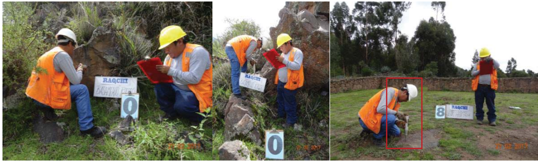
Figura 5.50: Ensayos Esclerométricos, en la Llaqta Inca de Raqchi , realizados en macizos rocosos aflorantes, que constituyen los suelos de fundación de las superestructuras de la Llaqta. Las características de la toma de valores de los índices de rebote, son: el número de impactos, la forma (horizontal o vertical), una superficie lisa y, seca. Fotografías, archivo personal, 2017.
