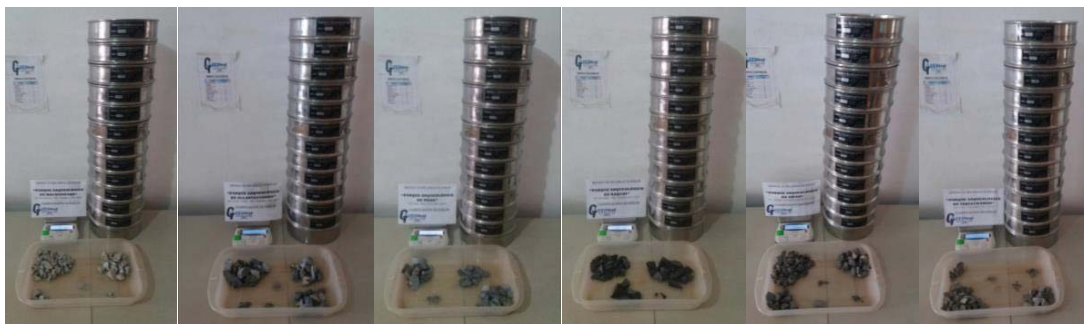
Figura 5.55: Ensayos de Análisis Granulométrico . Realizados a los suelos conformantes de los Rellenos Controlados Inca, RCI , de las Llaqtas Incas de Machupicchu, Ollantaytambo, Pisaq, Raqchi, Tipón y Saqsaywaman. Fotografías, archivo personal, 2017.
