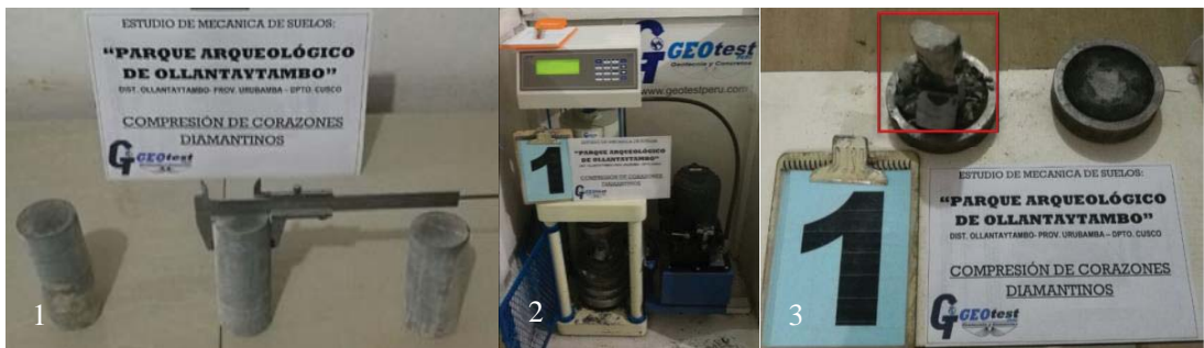
Figura 5.69: Ensayos de Compresión Simple No Confinada, de suelos de fundación de la Llaqta Inca de Ollantaytambo . (1) Corazones diamantinos de macizo rocoso de Arenisca cuarcita; (2) Ensayo de compresión de la Muestra; (3) Muestra ensayada, nótese fragmentación en dos partes, con un promedio de f'_c = 499 Kg. /Cm2. Fotografías, archivo personal, 2017.
