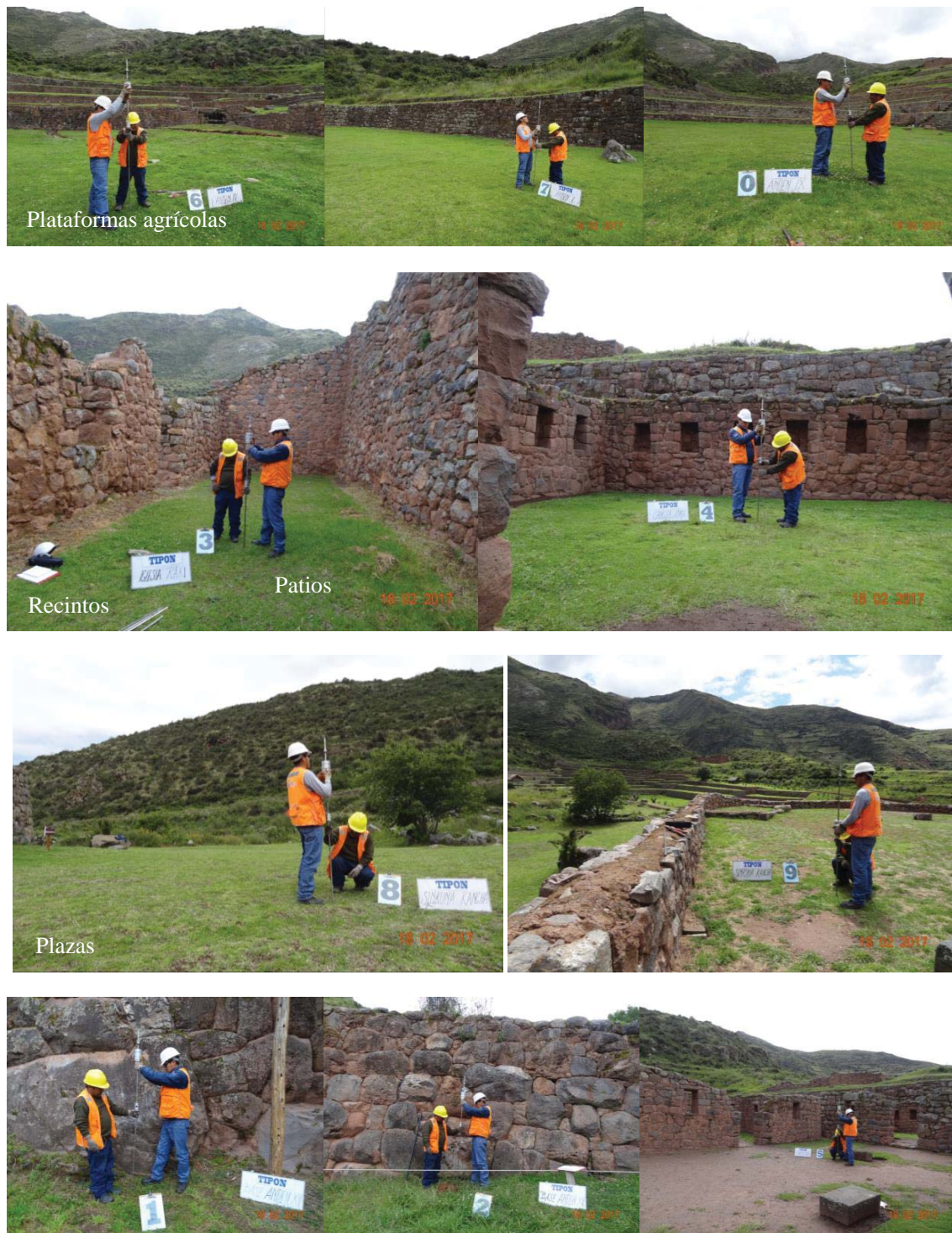
Figura 5.45: Ensayos In Situ con Penetrómetro Dinámico Ligero, en la Llaqta Inca de Tipón , realizados en plataformas agrícolas, recintos, plazas y patios; los sondeos realizados en esta Llaqta, evidencian el manejo de Rellenos Controlados Inca poco profundos por la cercana presencia de los macizos rocosos de fundación; esto debido entre otros, al limitado sistema edáfico del lugar. Se distingue bien el tratamiento de Rellenos Controlados Inca para cada tipo de superestructuras conformantes de la Llaqta. Fotografías, archivo personal, 2017.
