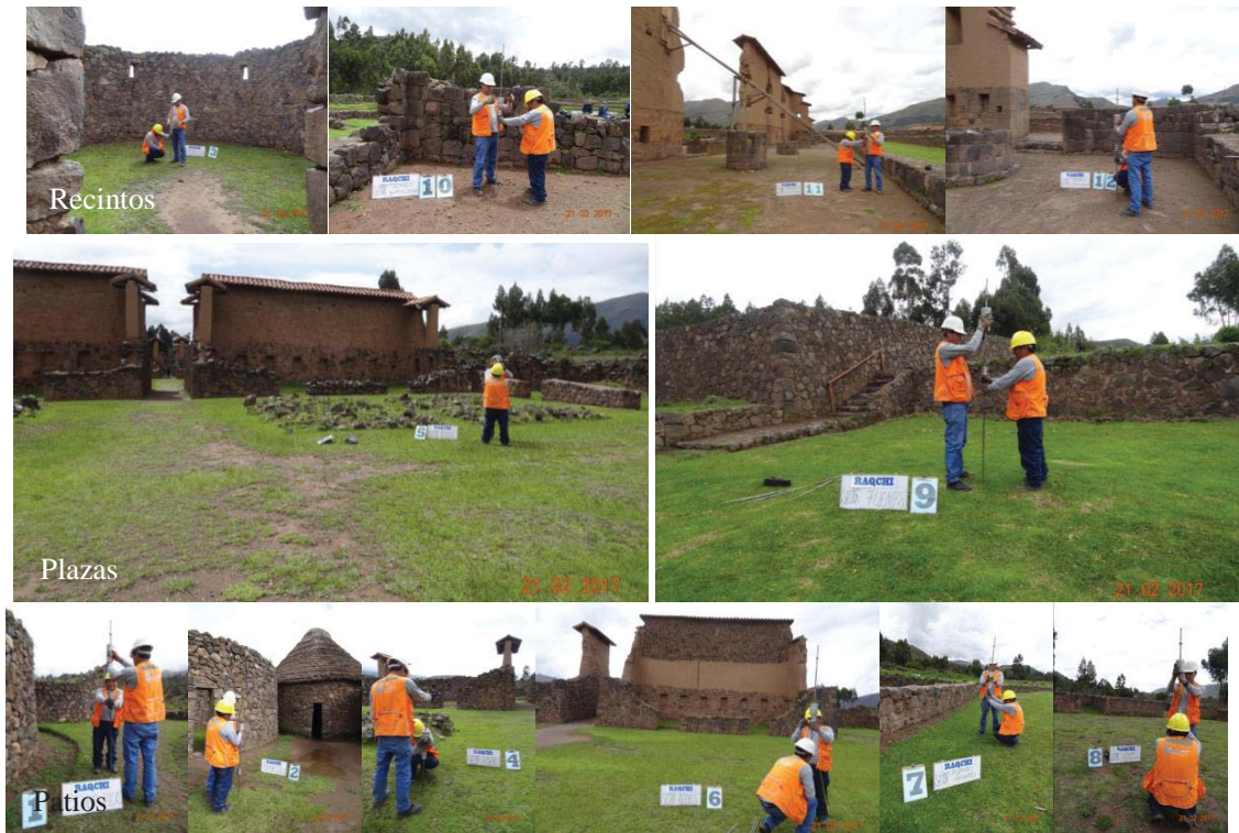
Figura 5.44: Ensayos In Situ con Penetrómetro Dinámico Ligero, en la Llaqta Inca de Raqchi , realizados en recintos, plazas y patios; los sondeos realizados en esta Llaqta, evidencian el manejo de Rellenos Controlados Inca profundos por la lejanía de los macizos rocosos de fundación; ello debido a masivos rellenos desarrollados para lograr una superficie uniforme. Se distinguen claramente el tratamiento de Rellenos Controlados Inca para cada tipo de superestructuras conformantes de la Llaqta. Fotografías, archivo personal, 2017.
