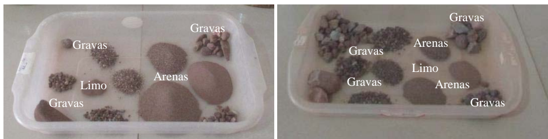
Figura 2.8: Suelos granulares: Gravass, Arenas y Limos. Muestras de gravas bien graduadas, (GW), por la variedad de tamaños que las conforman y que posibilitan un buen acomodo e integración en el momento de su utilización como material de cimiento. Fotografías facilitadas por el Laboratorio de Suelos, Geotest Perú, 2016.
