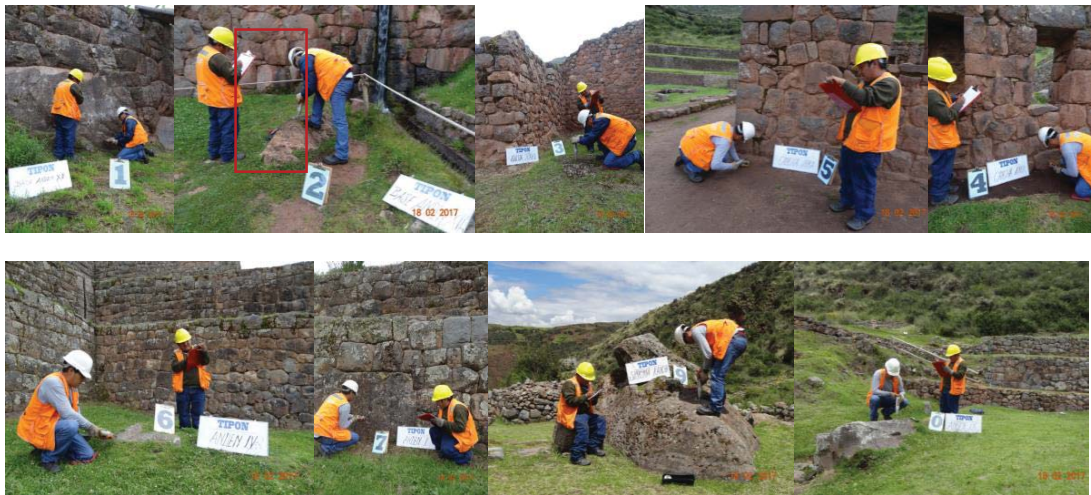
Figura 5.51: Ensayos Esclerométricos, en la Llaqta Inca de Tipón , realizados en macizos rocosos aflorantes, que constituyen los suelos de fundación de las superestructuras de la Llaqta. Los valores de rebote, permiten medir la dureza que presentan In Situ los macizos rocosos; constituyéndose este método, en el procedimiento más usado a nivel mundial. Fotografías, archivo personal, 2017.
