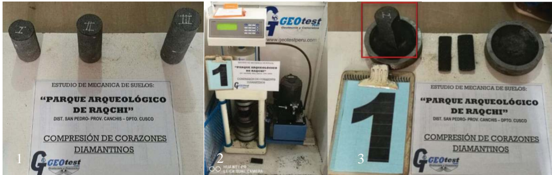
Figura 5.71: Ensayos de Compresión Simple No Confinada, de suelos de fundación de la Llaqta Inca de Raqchi . (1) Corazones diamantinos de macizo rocoso de Andesita; (2) Ensayo de Compresión no confinada de la Muestra; (3) Muestra ensayada, nótese la integridad del espécimen después del ensayo, con un promedio de f'c = 648 \text{ Kg. / Cm}^2 , lo que certifica la dureza y resistencia de la roca. Fotografías, archivo personal, 2017.
