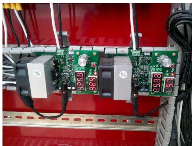
Figura 3-30 Cargas electrónicas de 60 W cada uno utilizadas para el estudio [Elaboración propia].
