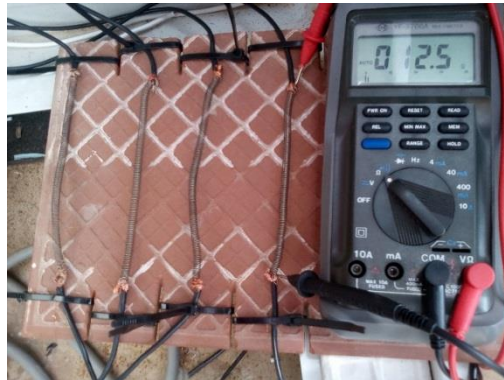
Figura 3-29 Cargas resistivas de nicrom cada uno utilizadas para el estudio [Elaboración propia].
