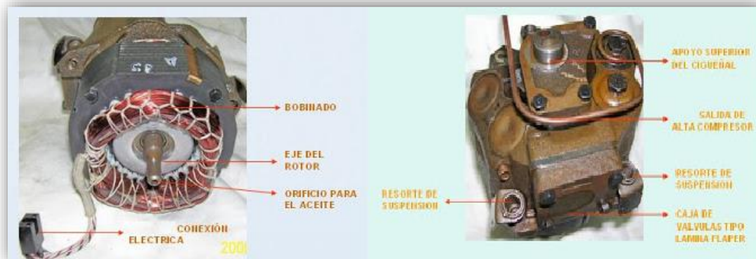
Figura 3. 62: Motor eléctrico y conjunto del compresor.
