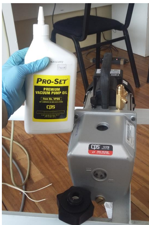
Figura 6. 8: Llenado de aceite para bomba de vacío CPS PRO-SET para pruebas reales.
