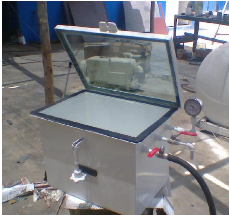
Figura 3. 74: Cámara de vacío fabricada con fierro estructural.
