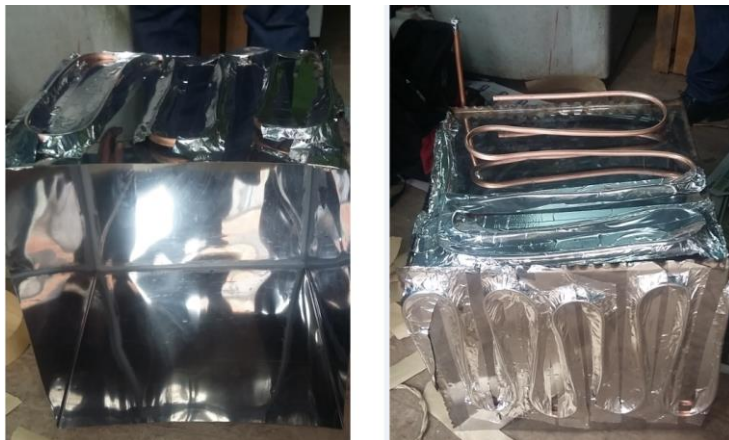
Figura 4. 18: Implementación del evaporador del sistema de enfriamiento.
